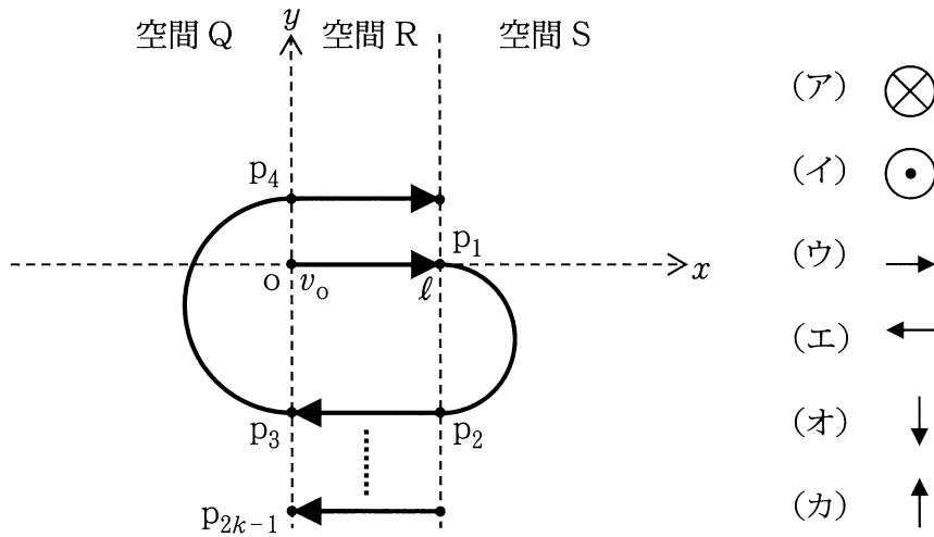
図のような  $xy$  平面において、質量  $m$  [kg]、電荷  $q$  [C] ( $q$  は正とする) の荷電粒子の運動を考える。空間 Q を  $x < 0$ 、空間 R を  $0 \leq x \leq \ell$  [m]、空間 S を  $\ell < x$  とする。空間 Q, S には同じ向きで磁束密度  $B$  [T] の一様な磁場、空間 R には一様な電場  $E$  [V/m] が存在し、電場の向きは空間 R に粒子が入射するのと同時に、粒子の進行方向と同じ向きに切り替わる。図中の実線は粒子の軌跡を示す。
